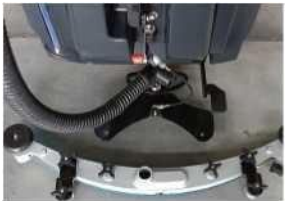
第1步: 拧下吸水脚十字旋钮, 通过提拉把手放下吸水脚摆尾支架;
